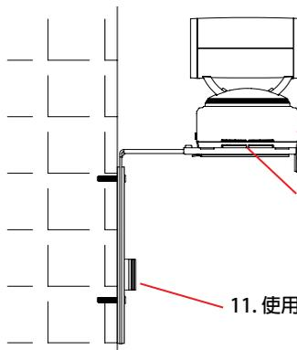
9. 將GVC3202置於支架A上。支架A上的定位針要能夠插入GVC3202底部的定位孔中。
