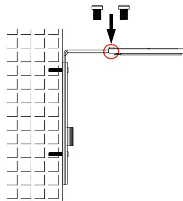
8. 將支架A和支架B在左圖所示的螺絲處對準。然後使用螺絲類型2從上往下裝入螺絲並擰緊。
