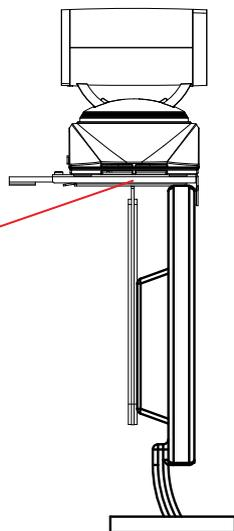
4. GVC3202與牆體安裝支架固定後，將牆體安裝支架從顯示設備後部放置於顯示設備頂上。小心滑動支架A和支架B，調整兩者之間的距離，確保顯示設備適當卡入支架A和支架B之間。
