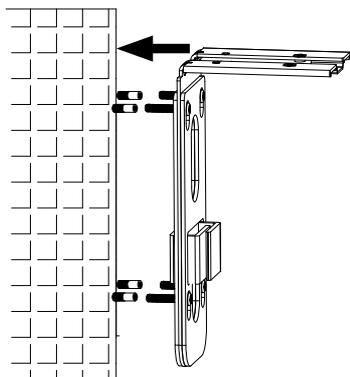
5. 將支架B放置到牆上，然後把螺絲類型3從支架B上的四個孔穿入到四個螺絲中，固定支架B。
