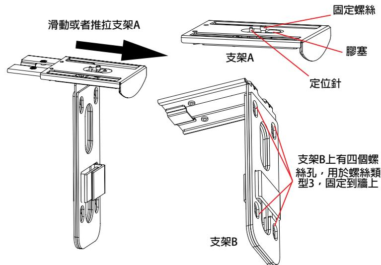
2. 在支架B上，有四個螺絲孔，用於螺絲類型3。將支架B靠在牆上並且移到需要安裝的位置。
